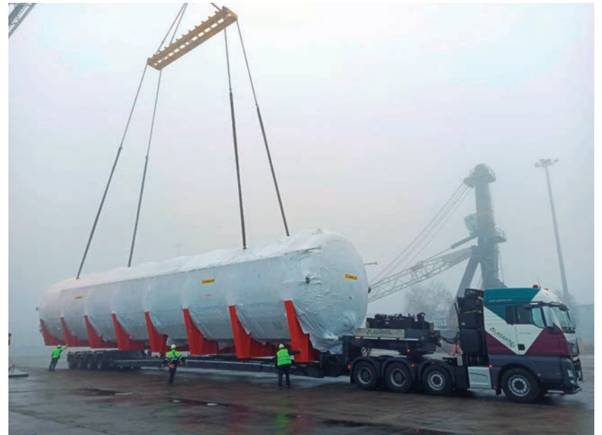
El tanque de fermentación, de 44 toneladas, es para una multinacional cervecera.
